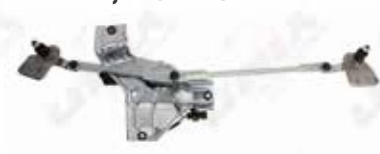
Mecanică ștergător parbriz cu motor
