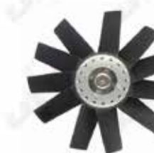
Viscocuplaj ventilator răcire (CASE IH, NEW HOLLAND)
