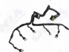
Sul cablu (injector)
