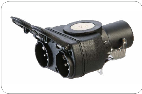
Kurzadapter mit 15P/24V Stecker (ISO 12098) und 2x 7P/24V Steckdose (ISO 1185 + ISO 3731) Short adapter with 15P/24V plug (ISO 12098) and 2x 7P/24V socket (ISO 1185 + ISO 3731)
