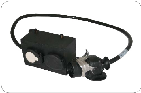
Adapterbox mit Leitung mit 15P/24V Stecker (ISO 12098) und 2x 7P/24V Steckdosen (ISO 1185 + ISO 3731) Adapter box with cable with 15P/24V plug (ISO 12098) and 2x 7P/24V socket (ISO 1185 + ISO 3731)
