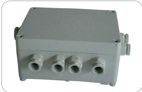
13P Verteilerbox mit 6,3mm Flachsteckanschlüssen (13x 6) und Kabelverschraubungen PG11 (6x) und PG16 (1x) 13P junction box with 6.3mm flat terminals (13x 6) and cap nuts PG11 (6x) and PG16 (1x)
