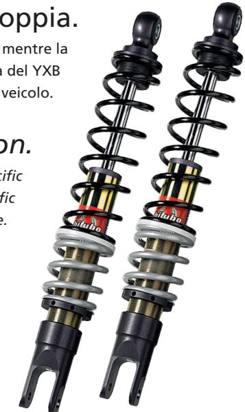
**CARATTERISTICHE TECNICHE** Corpo ammortizzatore e stelo in acciaio altoresistenziale trattato, testine superiori ed inferiori, e vaschetta esterna in lega di alluminio ricavate dal pieno con lavorazione CNC.
