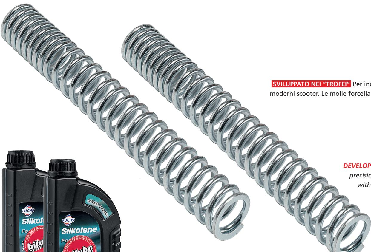
**N.B.** Le molle sono a caratteristica progressiva\* per aumentare il comfort e garantire stabilità in frenata sia per l'uso sportivo che a pieno carico. La confezione include Olio FUCHS-Silkolene dedicato alle caratteristiche del mezzo e le istruzioni di montaggio sono complete di indicazione tipo olio e relativa quantità.
