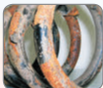
Broken Gebrochene Federwindung Vioittunut
