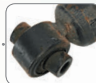
Damaged mounting Verschlissene Befestigung Vioittunut kiinnike
