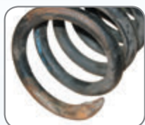
Rust Korrosion Ruoste
