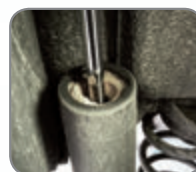
Broken bump Verschlissener Anschlagpuffer Vioittunut iskunvaimennin
