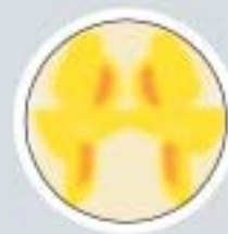
D Példa a fény eloszlására egy FF fényszóró buráján
