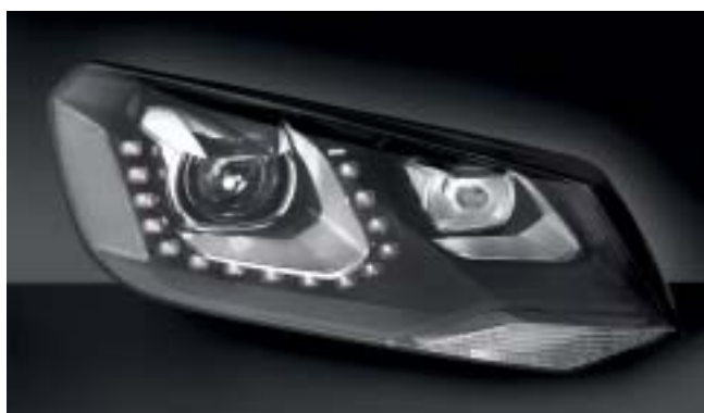
A vakításmentes távfényszórót többek között a VW Touareg típusnál alkalmazzák.
